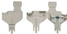
El enchufe para elementos de construcción se utiliza para integrar un componente eléctrico en un bloque de bornes seccionables. Después de soldar el componente electrónico, el conector macho se puede integrar en el área de desconexión de nuestros bloques de bornes seccionables y así cambia la regleta de bornes seccionables en una regleta de bornes modular con componente electrónico integrado.
