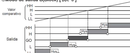
Valor de muestreo  $\geq$  valor comparativo HH ☞ HH salida ON
